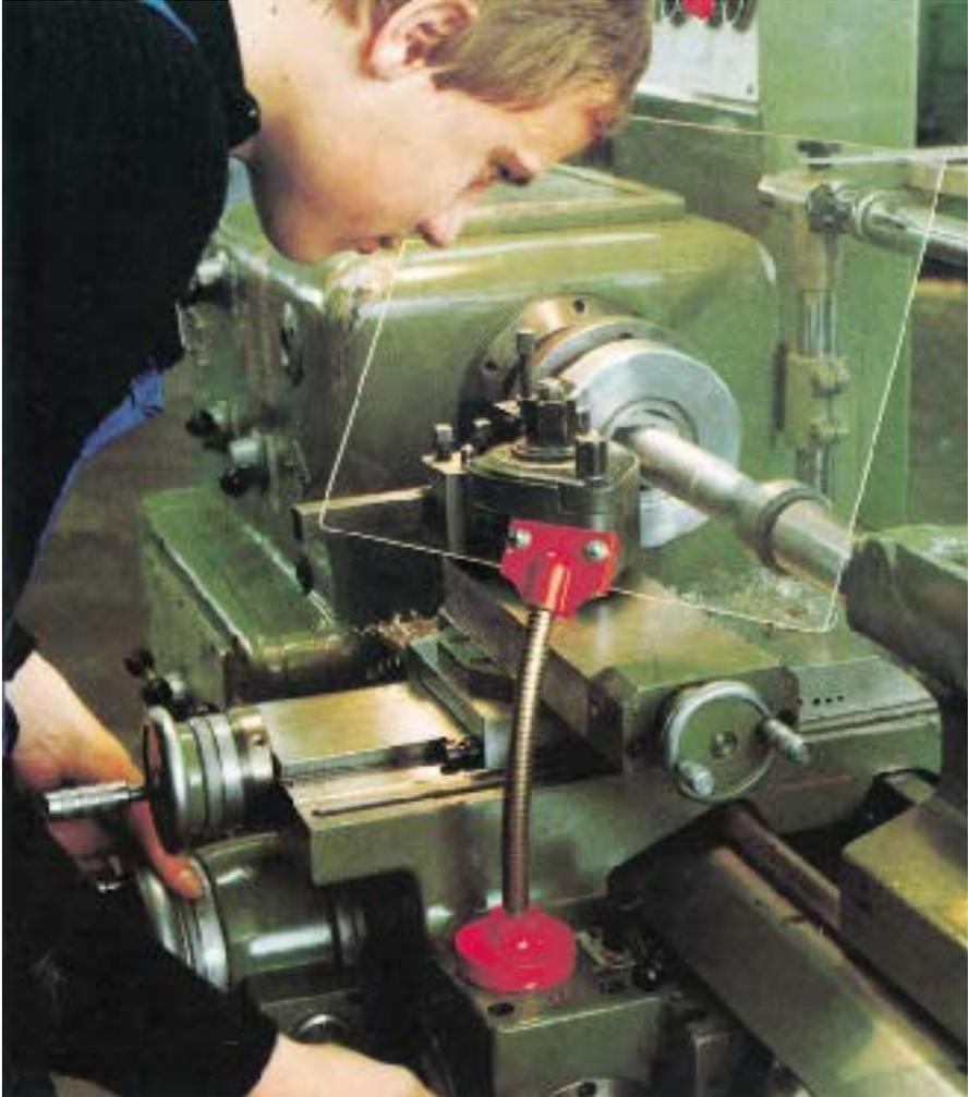
Bild 54: Späneschutz an einer Drehmaschine
