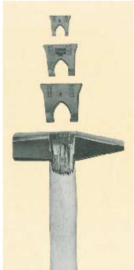
Bild 32: Geeignete Keile für die Befestigung von Holzstielen
