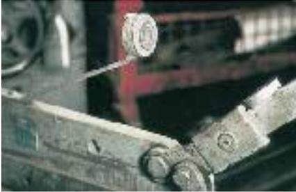
*Bild 48: Selbsttätig wirkende Sicherung für den hoch gestellten Hebel einer Handhebelschere, als Magnethalterung ausgeführt*
