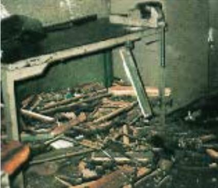
Bild 73: Durch Acetylen-Explosion zerstörte Werkbank
