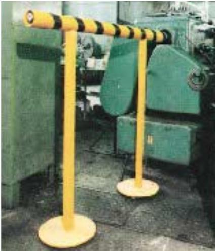
Bild 52: Stangenschutz an einer Drehmaschine
