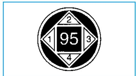
Bild 38: Prüfzeichen für Bolzenschubwerkzeug. Es ist bis zwei Jahre nach erfolgter Prüfung gültig. Die Zahl des Quartals, in dem das Gerät geprüft wurde, zeigt in Richtung der Laufmündung
