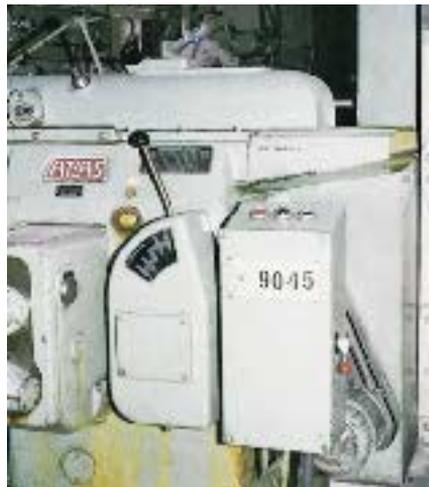
Bild 46: Sicherung der Quetschstelle am Kurzhobler
