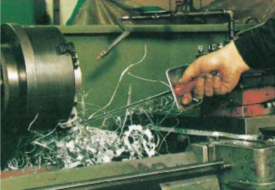
Bild 51: Späneheken mit Heftgriff und Handschutzschild
