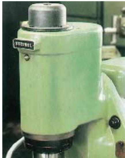
Bild 43: Verkleidung eines Wellenendes
