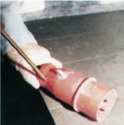
Bild 25: Kupplung nach CEE-Norm
