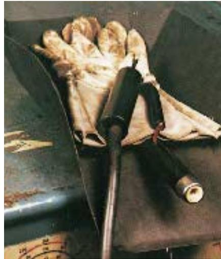
*Bild 80: Ohne Elektrodenrest isoliert abgelegter Stabelektrodenhalter*
