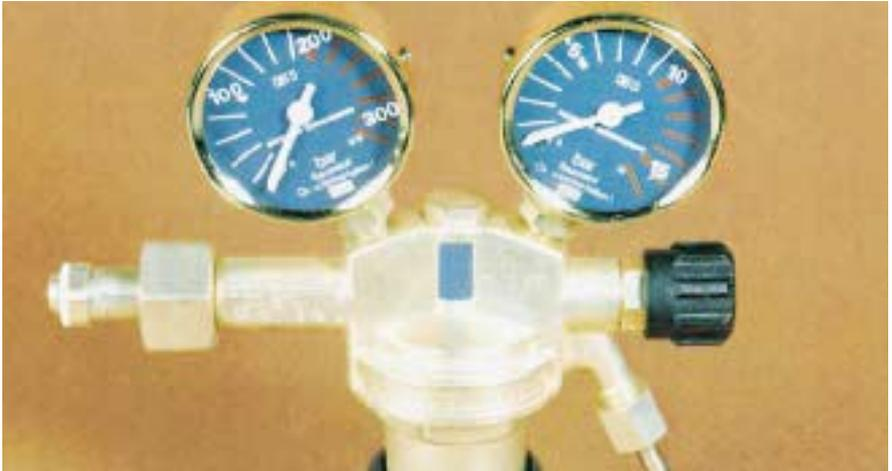
Bild 70: Acetylen-Flaschendruckminderer mit staatlichem Bauartzulassungskennzeichen (rechts am Gehäuse) und Sicherheitsmanometern
