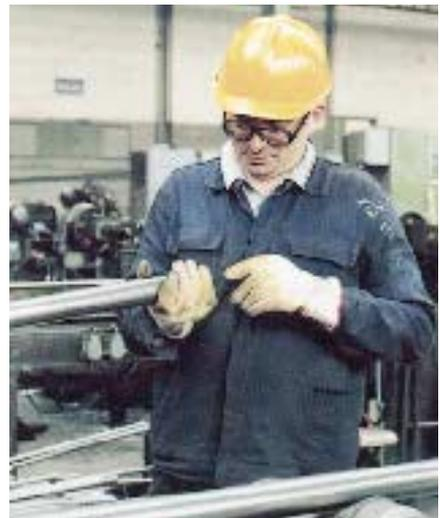
*Bild 16: Bei der Kontrolle von Werkstücken sind Schutzhandschuhe zu tragen.*
