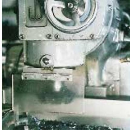
Bild 45: Schutzvorrichtung an einer Fräsmaschine
